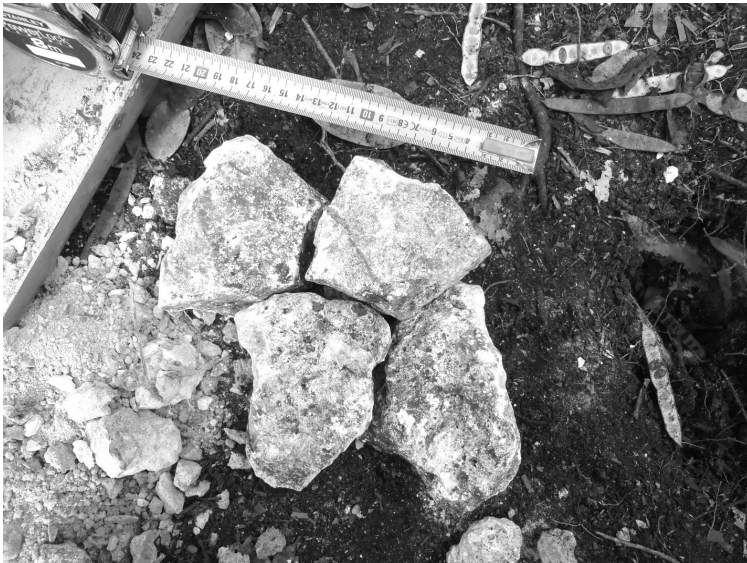
Foto 6.2 Ejemplo de piedra caliza cortada de una capa de pavimento en la ubicación Transecto 3 Núcleo 49 Foto: Matthew Ricker 2016
