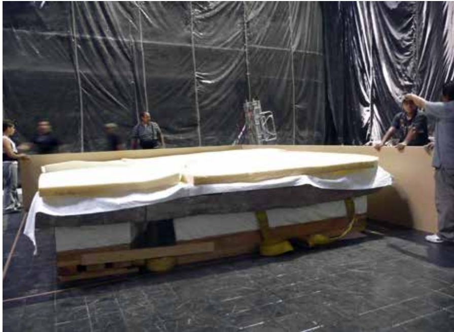
FIGURA 184. Inicio de armado de la caja de protección (MBR).
