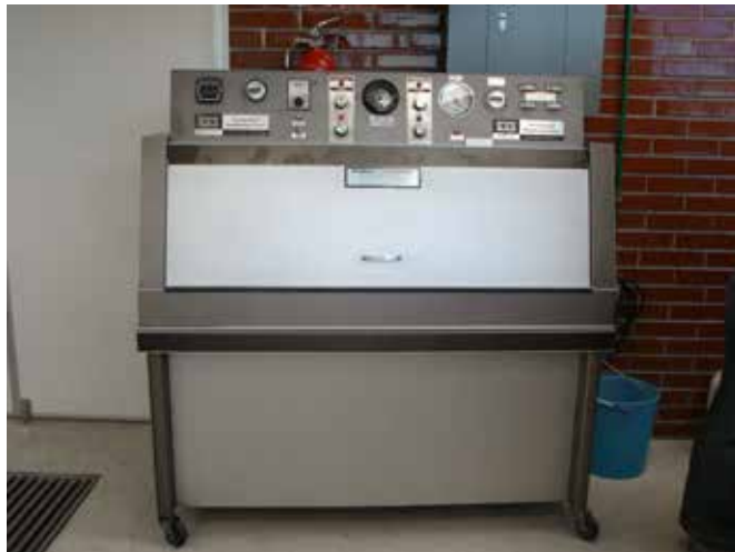
FIGURA 95. Cámara de envejecimiento acelerado (CBM).
