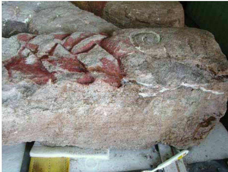
FIGURA 81. Resane en proceso de reintegración cromática (CBM).
