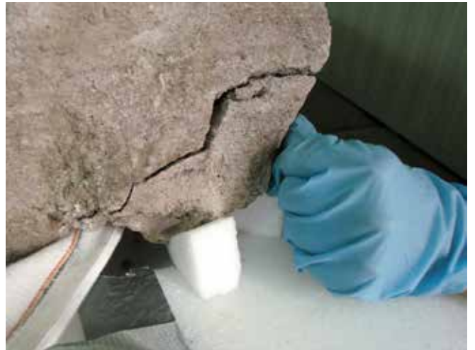
FIGURA 86. Proceso de unión con resina epóxica (CML).
