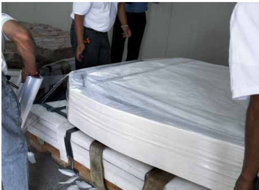
FIGURA 160. Sujeción del embalaje con película autoadherible (JMG).
