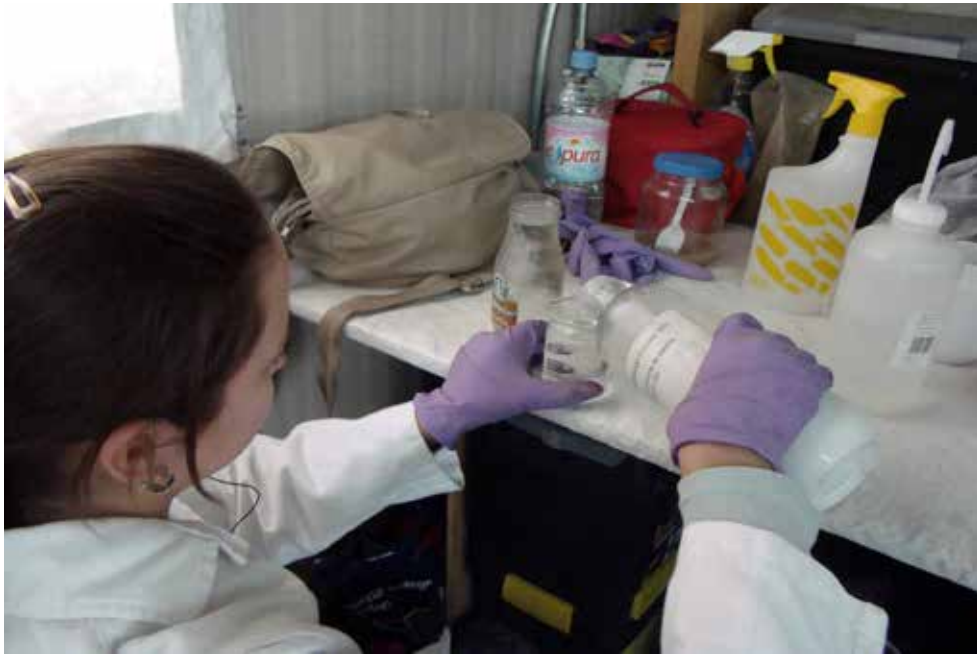
FIGURA 142. Preparación del consolidante KSE 300 ® 1:1 en alcohol etílico (MBR).
