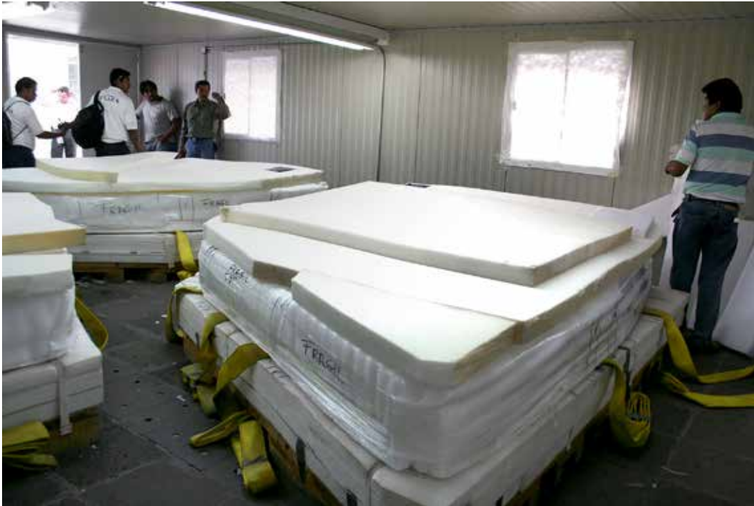
FIGURA 162. Placas de espuma de poliuretano (JMG).
