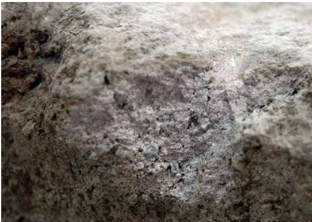
FIGURA 1. Textura porfídica en la andesita de lamprobolita (JTT).
