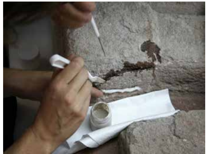
FIGURA 92. Pruebas de consolidación en zona con exfoliación (MBR).
