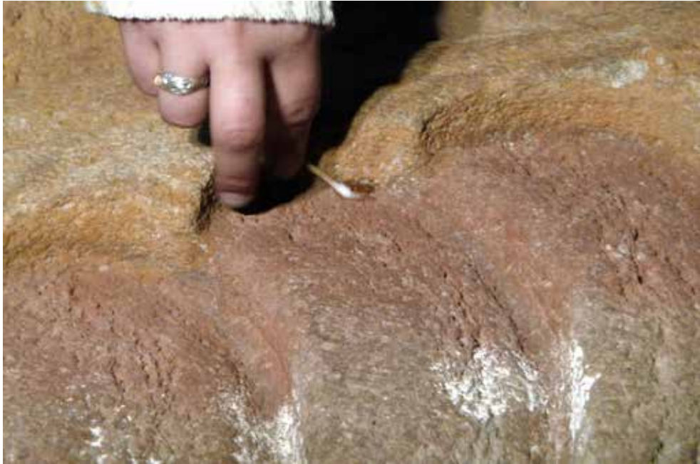
FIGURA 146. Pruebas con hisopo rodado para evaluar el fijado (MBR).
