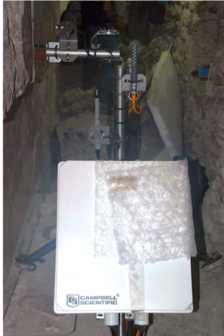
Figura 8.1.4. Estación 1 de Monitoreo Ambiental, el que registra la información. (Fotografía B. Beltrán, 2012).
